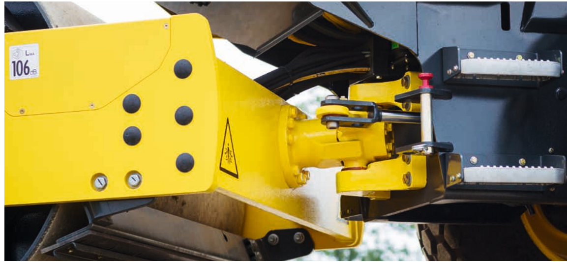
Sauber gemacht: Das Knickgelenk ist wartungsfrei, die Maschine kommt komplett ohne Abschmieren aus.
