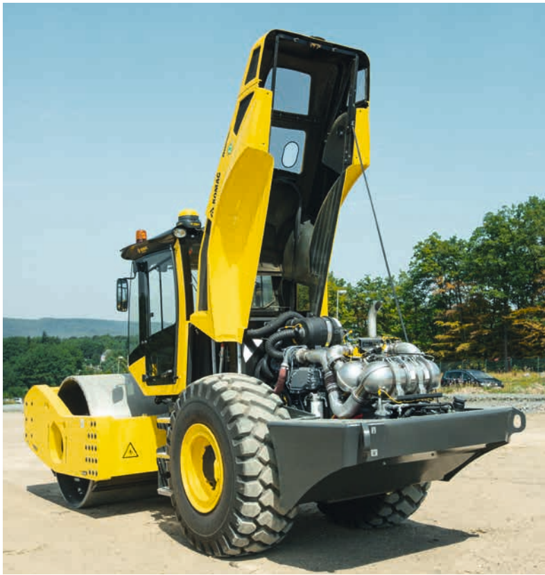
Große Klappe willkommen: alle Wartungspunkte einfach zugänglich.
