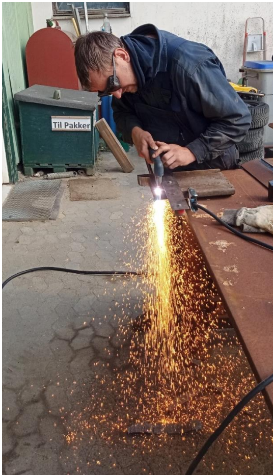
Manuel kontaktskæring i 40 mm Hardox stål efter skinne. Helt ret snit og god vinkelrethed fra top til bund.
