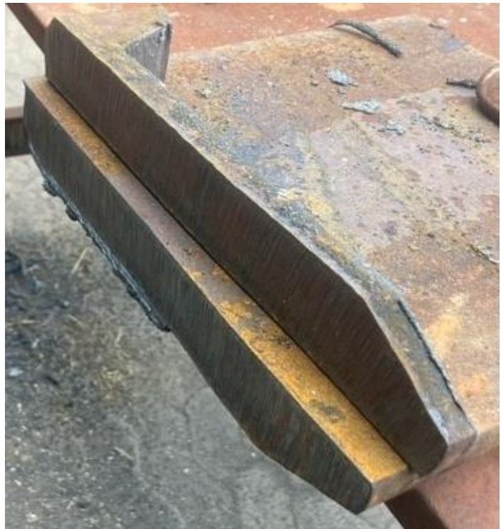
Manuel kontaktskæring i 40 mm Hardox stål efter skinne. Helt ret snit og god vinkelrethed fra top til bund.
