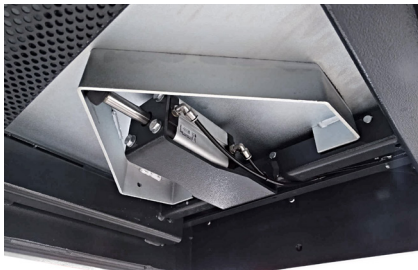
Bloccaggio e sbloccaggio pneumatico delle piastre oscillanti Pneumatic lock and unlock of the sliding plates
