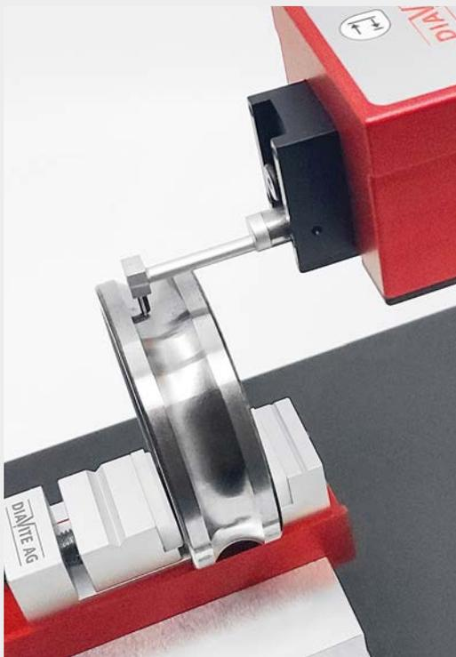
Messung mit Messstativ und einem KKH-Kufentaster geeignet für konkave und konvexe Oberflächen zum Beispiel Kugellagerführung.
