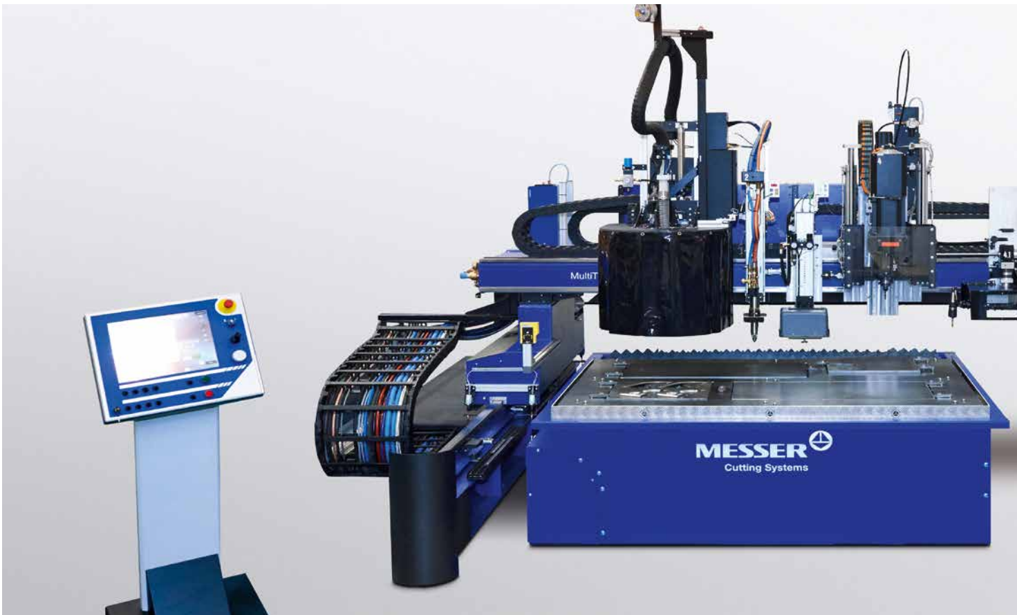
Mit dem Skew Delta können Plasma-Fasenschnitte schnell und einfach ausgeführt werden.
