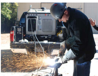
Håndholdt skæring på arbejdspladsen
