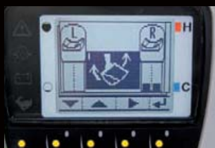
Max. indstilling af olieflow via hydraulikudtag (SP1 og SP2)
